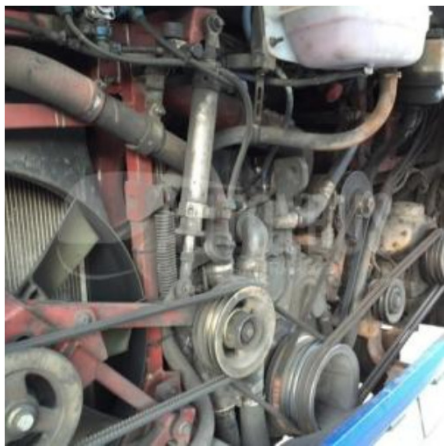
Detall de la part posterior. Motor, radiador i les corretges de ventilador i d'aire condicionat
